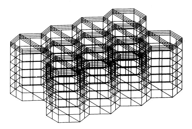
Fig. 7 MODEL OF SECTION OF 1.8m HONEYCOMB MIRROR BLANK
