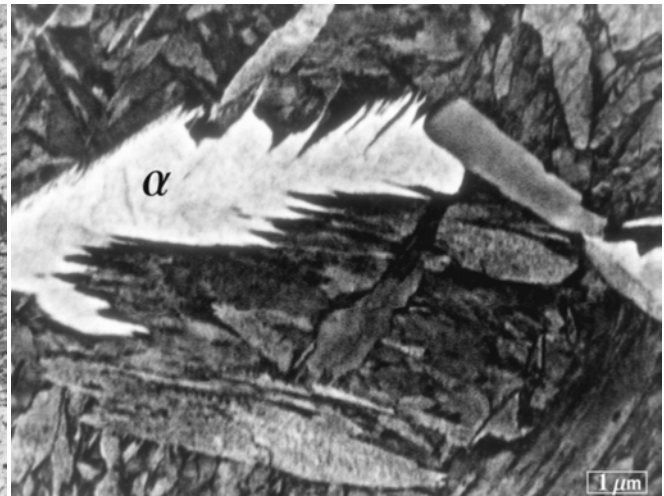
Fig. 4 Lath Martensite in AMB 16 Steel.
