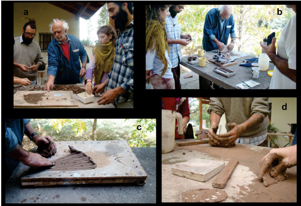
Figura 4. Experimentación en campo. (a) Limpieza manual de arcillas; (b) molido de la arcilla; (c) homogeneización de arcilla para la eliminación de grumos; (d) amasado de la arcilla. (Color en la versión electrónica)
