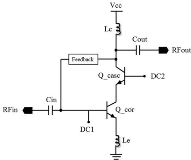
Fig. 7. LNA architecture.
