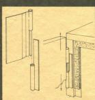
LIFT-OFF SAFE TYPE HINGE
