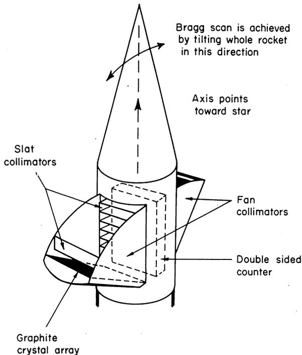
Fig. 1. The spectrometer.
